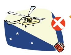
Wenn Sie nachts mit Helikoptern arbeiten, beleuchten Sie den Bereich des Decks. **RICHTEN SIE KEIN SUCHLICHT** nachts auf den Helikopter, weil die Piloten Nachtsichtbrillen tragen und durch den Lichtstrahl zeitweilig erblinden.
