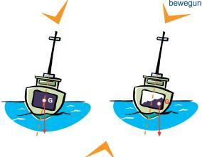
DIESE WIRKUNG DER "FREIEN FLÜSSIGKEITSOBERFLÄ-CHE" ERHÖHT DIE GEFAHR DES KENTERNS. Der Schwerpunkt verlagert sich seitwärts und macht das Schiff instabil. Um diese Wirkung der frei Flüssigkeitsoberfläche zu vermeiden, sollten Sie versuchen, möglichst wenig teilweise gefüllte Tanks oder Abteilungen zu haben.
