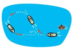
Das Manöver "Mann über Bord" ("Williamson Turn") ist scharf in Richtung Opfer auszuführen, bis man 60° zum ursprünglichen Kurs ausgeführt hat; dann wird das Ruder hart auf Gegenseite übergebracht, damit das Schiff auf Gegenkurs gelangt. Auf diese Weise müsste das Opfer vor dem Schiff zu sehen sein.
