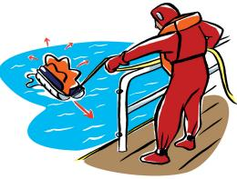
LÖSEN Sie die Befestigungen WERFEN Sie das Floß aus ZIEHEN Sie die Fangleine, um das Floß aufzublasen
