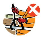
**BEFESTIGEN** Sie das Windenkabel nicht am Schiff.
